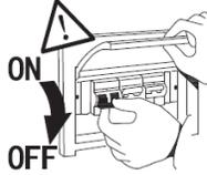
Desconecte la alimentación Eléctrica antes de instalar o realizar limpieza a la luminaria.
