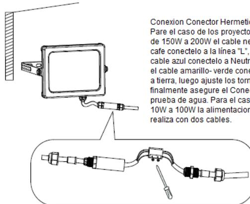
Conexión Conector Hermético: Pare el caso de los proyectores de 150W a 200W el cable negro ó café conectelo a la línea "L", el cable azul conectelo a Neutro "N", el cable amarillo-verde conectelo a tierra, luego ajuste los tornillos, finalmente asegure el Conector a prueba de agua. Para el caso de 10W a 100W la alimentación se realiza con dos cables.
