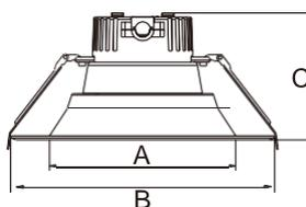
Antes de instalar y abrir el agujero en el techo drywall, verifique directamente las medidas con el producto adquirido.
