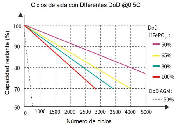
\*Gráficas de referencia acerca del funcionamiento de una batería de Litio, cada referencia individual podría tener un comportamiento distinto
