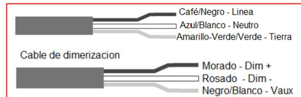
NOTA: Se debe asegurar la conexión a tierra para el correcto funcionamiento de las protecciones. Si no se emplea atenuación 0-10V, los cables Dim+ Dim- no deben conectarse.
